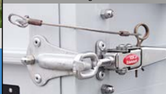
V2A Edelstahl Spannbeschlag für lebenslange Funktion
