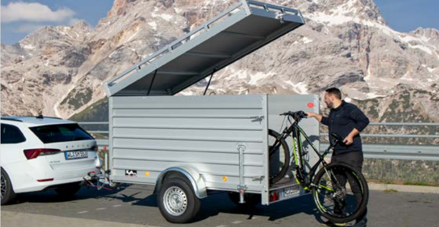
125.250 1,3 t Bordwanderhöhe 60 cm mit Deckel und Heckklappe als Tür
