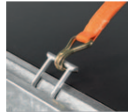
4 Anbindepunkt in V-Profil (Standard) DIN 400 daN (kg)
