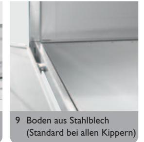
9 Boden aus Stahlblech (Standard bei allen Kippern)
