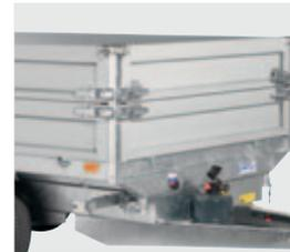
1 Wände aufsatz (oben scharnierend)
