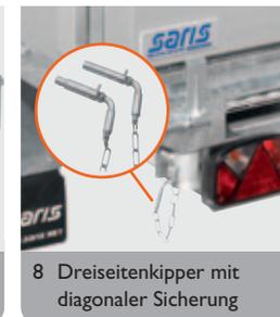
8 Dreiseitenkipper mit diagonaler Sicherung
