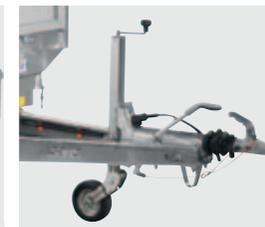
8 Automatikstützrad (Standard bei allen Kippern)
