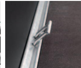
5 Anbindepunkte in V-Profil (Standard) DIN 400 daN (kg)
